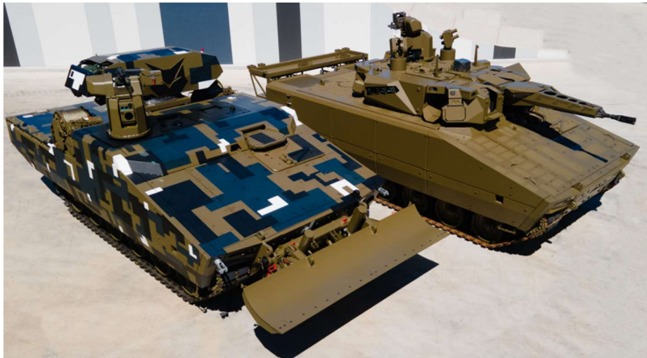
19. számú ábra. A Lynx KF41-es harcjárműből (jobbra fent) átalakított műszaki felderítő jármű. 835
