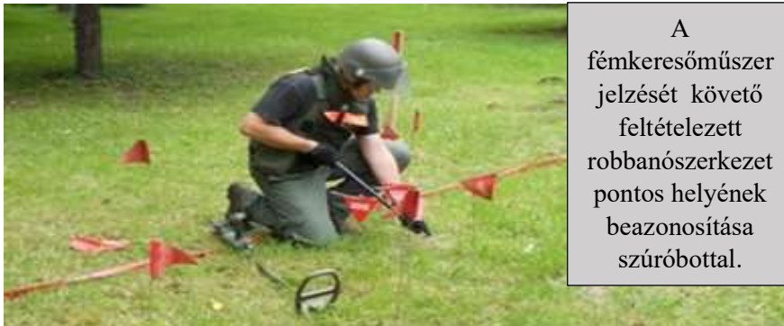
13. számú ábra. A robbanóeszköz beazonosításának kézi módszerei. 446
