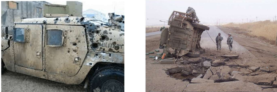
8. számú ábra. Az afganisztáni- és az iraki hadszíntéren általánosan alkalmazott kerekes harcjárművek EFP (baloldali kép). 367 A nyomásra működő PPIED (jobboldali kép) 368 alkalmazásának következményei.
